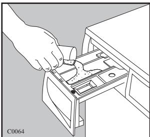
При необходимости насыпьте смягчитель тканей в отделение дозатора, помеченное символом , (засыпанное количество не должно быть выше метки "МАХ" на дозаторе). Осторожно закройте дозатор моющих средств.
