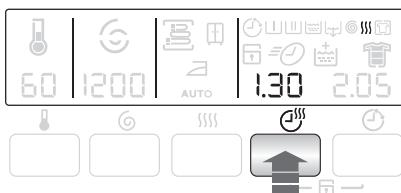
Если Вы хотите выполнить "электронную" сушку, нажмите кнопку "Автоматическая сушка" до тех пор, пока на дисплее не появится значок, соответствующий нужной степени сушки, помеченный символом .
