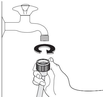
**ВАЖНО! Не используйте для подключения к водопроводу шланг от старой машины.**
